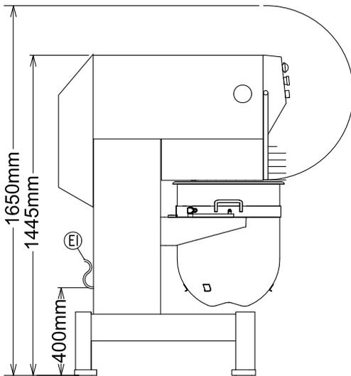
EI = Conexión eléctrica (energía)
